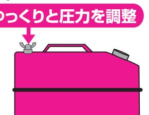
警 告 内部の圧力を調整せずに給油キャップを開けると中身がふき出る恐れがあり非常に危険です。必ず圧力を調整してください。
