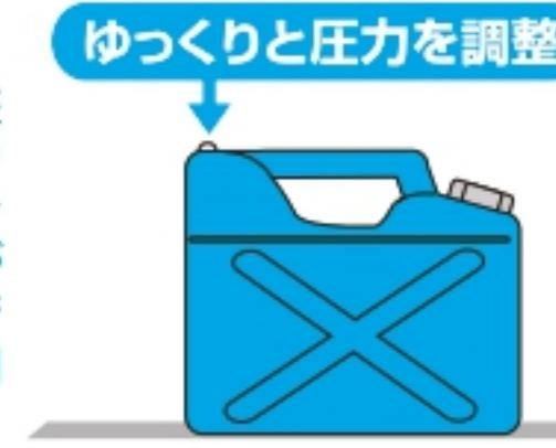
④給油後はウエス等できれいに拭き取ってください。ガソリン携帯缶内にガソリンが残る場合は、キャップ・エア調整ネジをしっかりと確実にしめてください。
